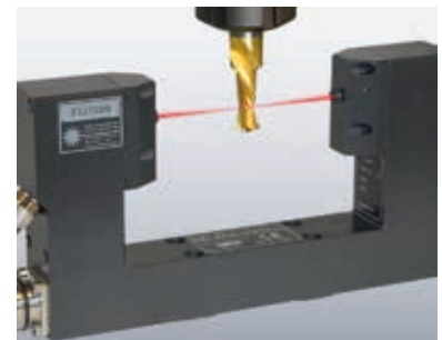
Бесконтактный контроль инструмента любой формы
